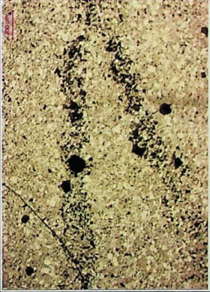
Foto b) vênula de sulfetos (opacos), com borda de carbonato, intrudindo arcóseo fino
