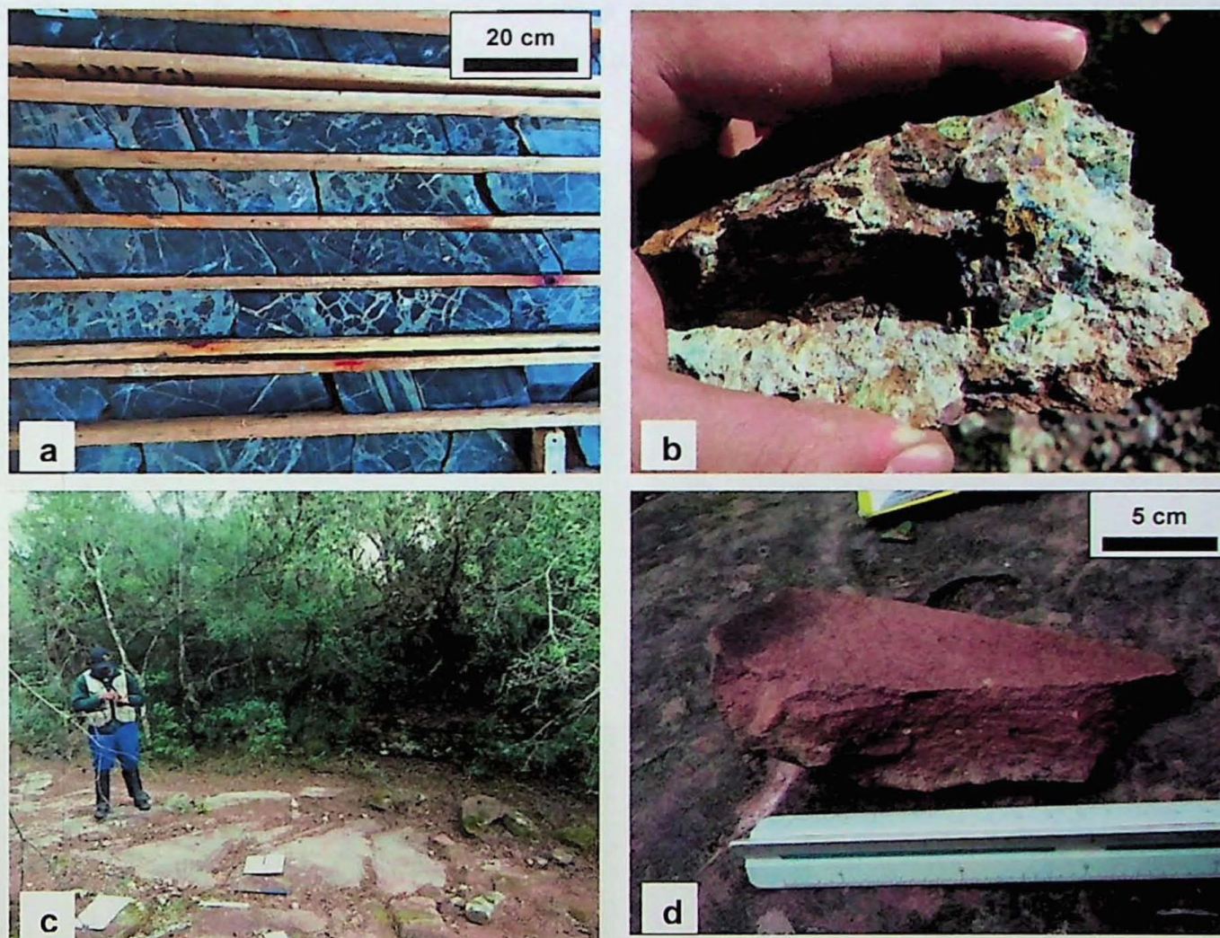
Figura 6.1: a. Ritmito em estrutura stockwork com vênulas de quartzo, barita e calcita placóide. b. Fragmento de veio de barita com malaquita, crisocola, azurita e calcopirita. c. Laje planar de arenito arcoseano. d. Detalhe do arenito arcoseano, composto essencialmente por quartzo e feldspato potássico, sendo a cor avermelhada dada pelo cimento limonítico.
